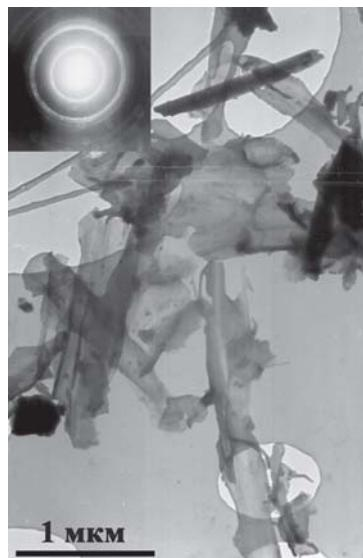
Ксеноморфные частицы графита и соответствующая картина электронной дифракции. Данные просвечивающей электронной микроскопии, снято на микроскопе Tesla BS500 (Чехия), напряжение 60 кВ
