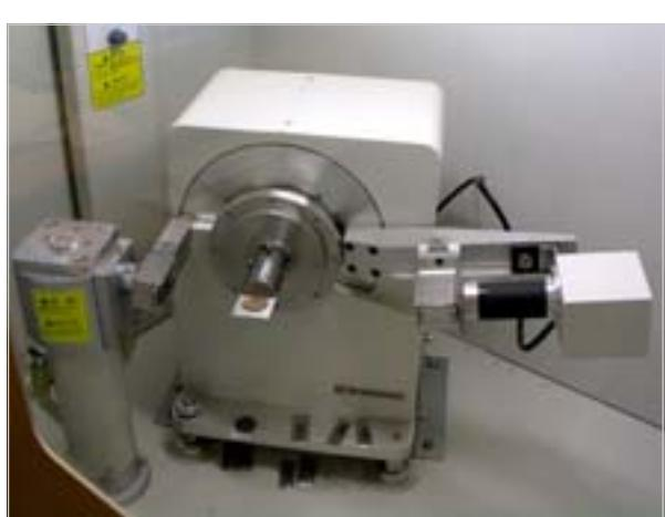
Порошковый дифрактометр (Shimadzu)
