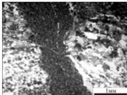
**Рис. 10.** Конформные границы гальки кислого эффузива. Справа обломок мелкозернистого песчаника, слева — полевошпат-кварцевого алевролита. Обр. 1, галька 70
