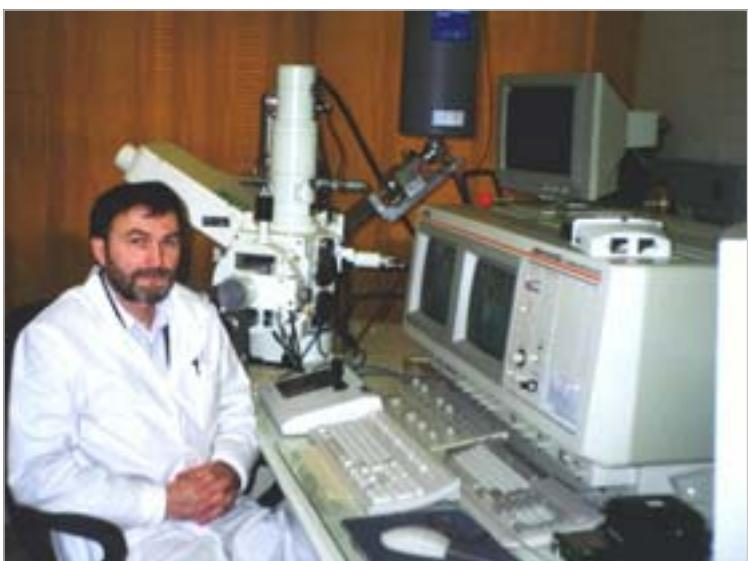
Сканирующий электронный микроскоп JSM 6400.
