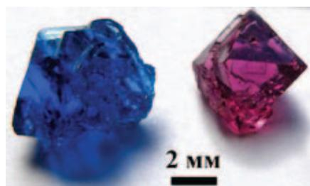
Монокристаллы ювелирной шпинели — ганита ( $ZnAl_2O_4$ ), выращенные в ВНИИСИМСе и переданные на исследования Л. А. Попугаевой — первооткрывательнице алмазоносных кимберлитовых трубок в России
