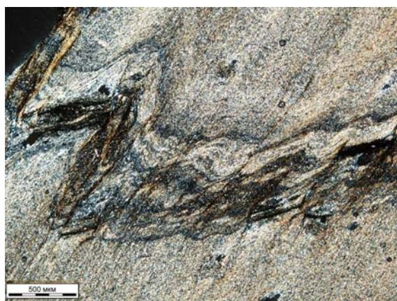
Рис. 1. Реликтовая слоистость в рифейских черных сланцах паунской свиты, обусловленная примесью тонкодисперсного углеродистого вещества (микрофотография без анализатора)
