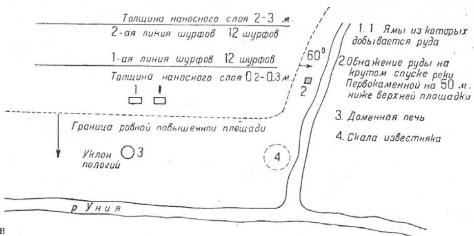
Рис. 4. Схема расположения домны Усть-Бердышского завода и месторождения железной руды на р. Унье [4]
