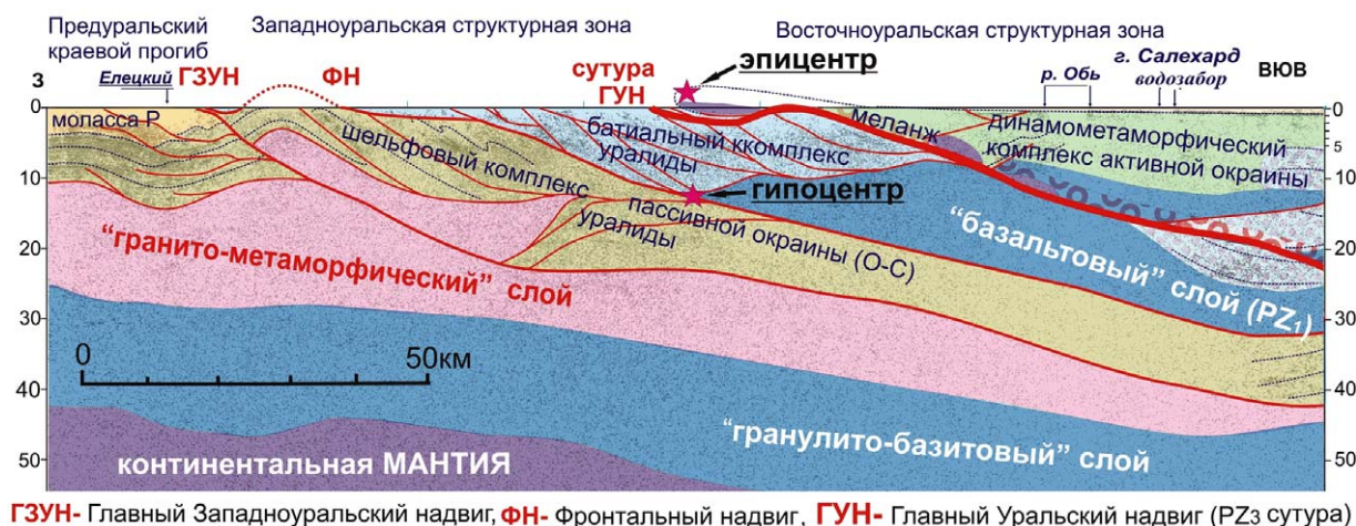
Рис. 4. Фрагмент геолого-геофизического профиля по [15] с вынесенным эпицентром и гипоцентром сейсмического события 24 декабря 2012 г. (составили В. В. Юдин, Д. Н. Ремизов, 2014 г.)
