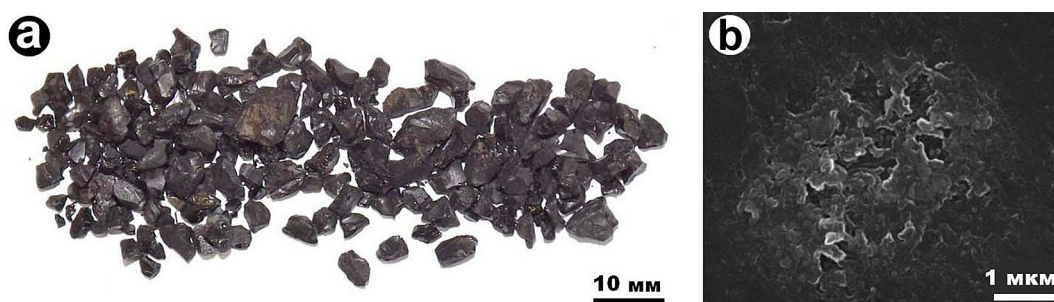
Рис. 4. Внешний вид (а) и микрокавернозность (б, СЭМ-изображение в режиме вторичных электронов) твердых битумов из миндалекаменных андезибазальтов
