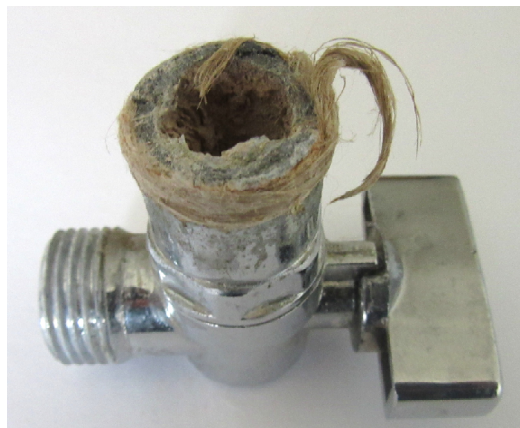
Рис. 1. Кран батареи центрального отопления и следы коррозии на нем
