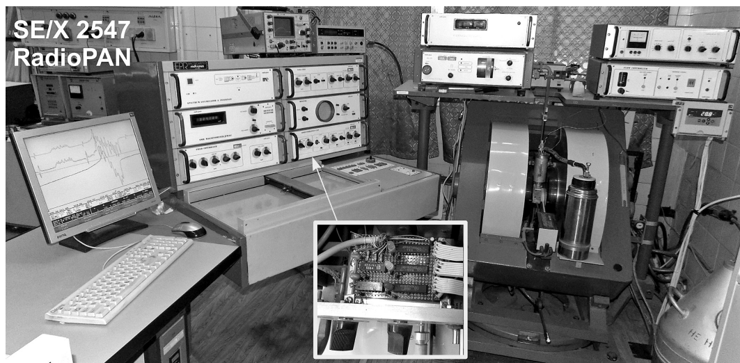
Фото 4. Модернизированный спектрометр ЭПР SE/X 2547. На врезке показана плата считывания параметров усилительного тракта
