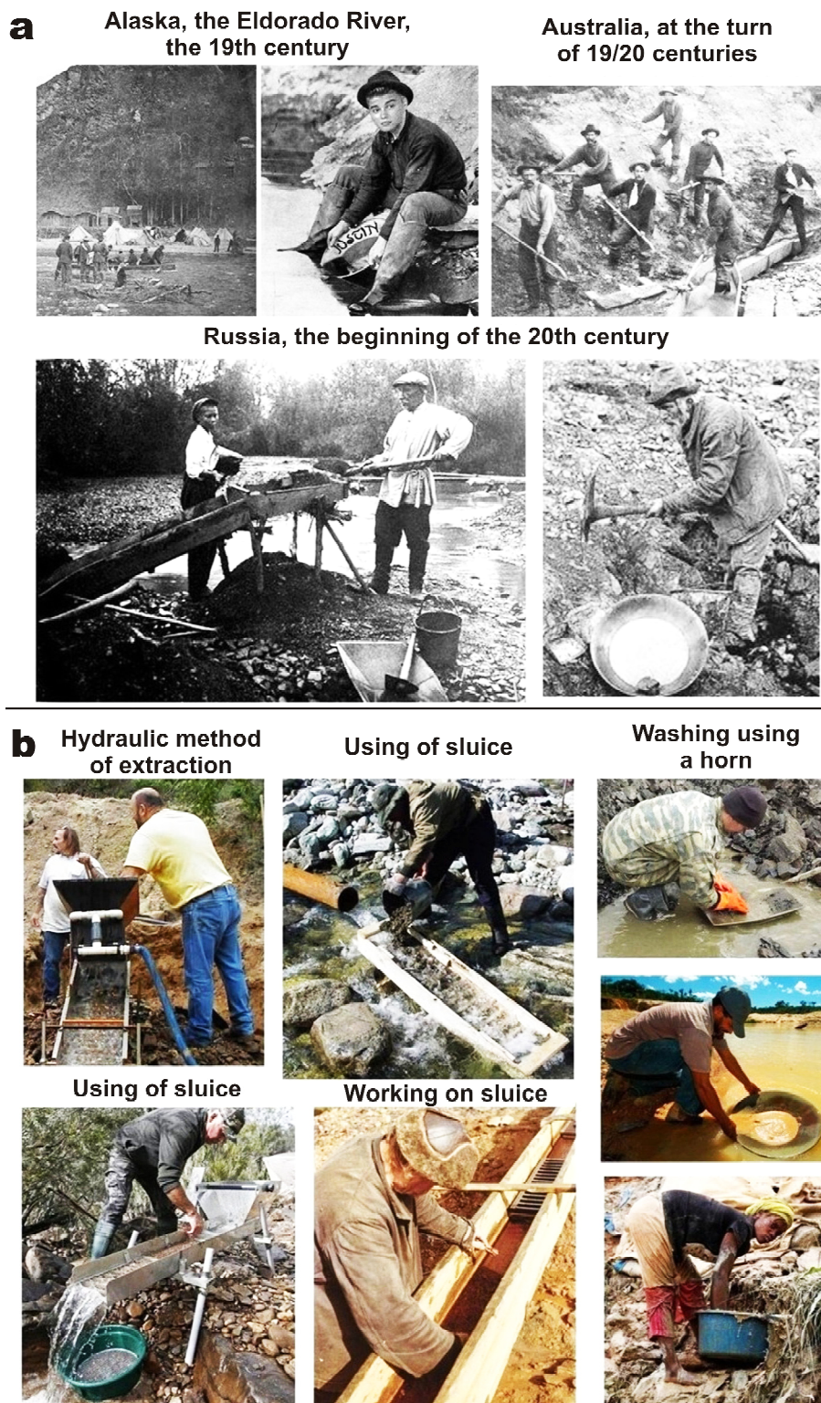
Рис. 2. Методы первичного гравитационного обогащения речных россыпей в эпоху первых «золотых лихорадок» 1880—1915 гг. (а) и в конце XX — начале XXI в. (б)
