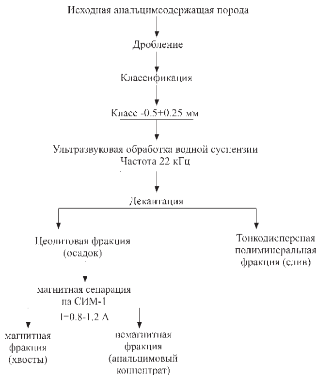
Технологическая схема обогащения аналцимсодержащих пород Тимана (на примере Веслянской группы проявлений)
