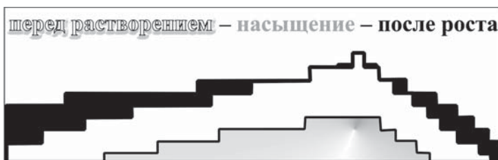
Рисунок 3.9. Три профиля одного холмика по данным АСМ: за час до точки насыщения перед растворением (белый профиль), в точке максимального растворения (серый профиль) и через час роста (черный профиль).
