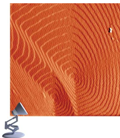
Рисунок 2.24. Мысленно поставив лампу в точке, из которой игла начинает сканирование участка, можно научиться понимать, холмики или ямки представлены на изображении.
