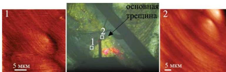
Рисунок 3.67. Два участка (1, 2) цепочки дислокаций, образовавшейся над основной трещиной.
