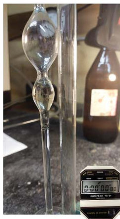
Рисунок 2.5. Динамическая вязкость растворов диоксида по сравнению с вязкостью воды.
