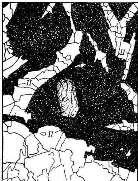
Рис. 44. Циркон II (циртолит) с включениями циркона I. Метагранит из зоны преимущественной альбитизации. Николи ||, увел. 160.
