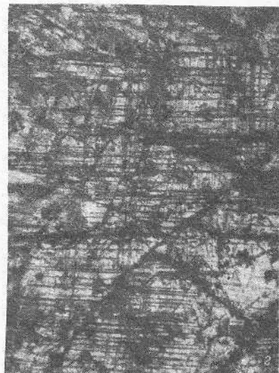
Рис. 118. Плоскости скольжения в кристаллах магнетита из Горной Шории, выявленные искусственным травлением. Проходящий свет. Увел. 120.
