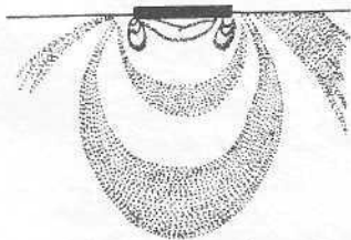
Рис. 62. Изохромы, возникающие в изотропном упругом полупространстве при вдавливании жесткого наконечника с острыми углами.
