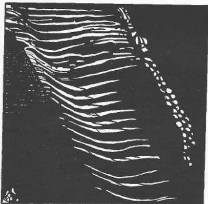
Рис. 133. Изогнутые двойниковые пластинки антимонита. Увел. 80.
