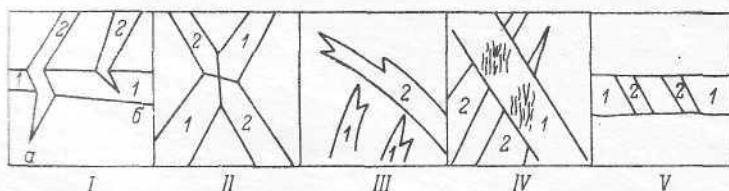
Рис. 34. Схемы пересечений двойниковых прослоек 1 и 2 (по Старцеву и др., 1956).
