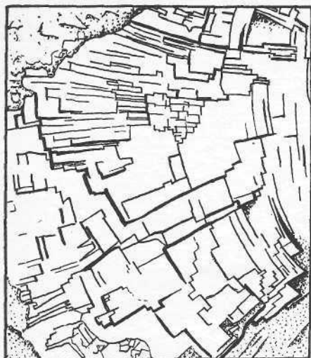
Рис. 131. Изгиб галенита с образованием блоков. Березовское золоторудное месторождение, Урал (по Григорьеву, 1958). Увел. 3.
