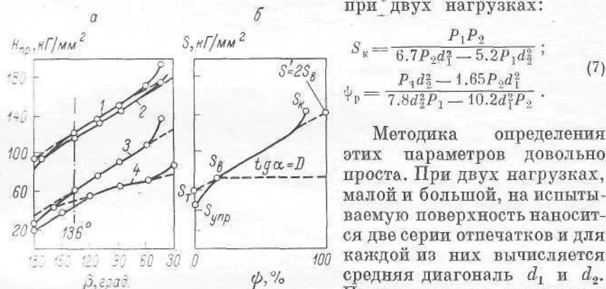
Рис. 90. Влияние формы наконечника на величину твердости (по Григоровичу, 1965).
