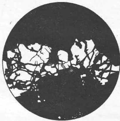
Рис. 141. Хрупкий разрыв пирита. Приполярный Урал. Увел. 80.
