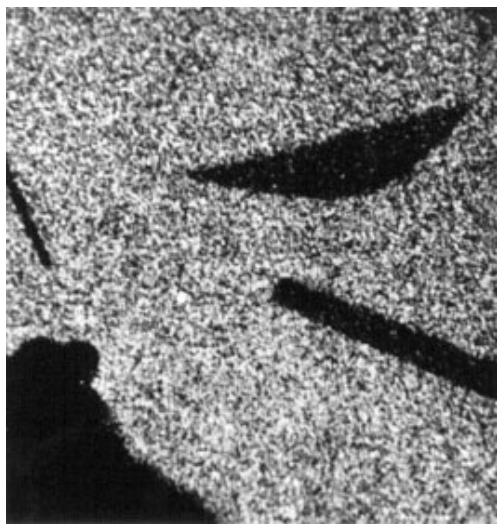
Рис. 2.1.1. Включение самородного осмия в изоферроплатине, россыпь р. Косью, Вересово-борский массив, Средний Урал. Снимок в характеристическом излучении M_{\alpha}Pt .
