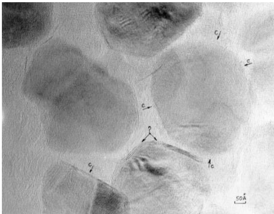
Рис. 1.3.1. Наноиндивиды сурьмы и кварца в шунгите. Видны структуры упорядоченности графитовых слоёв шунгитового углерода и индивидов сурьмы (показаны стрелками С), отсутствующие около зёрен кварца. НТЕМ. Фото В.В.Ковалевского
