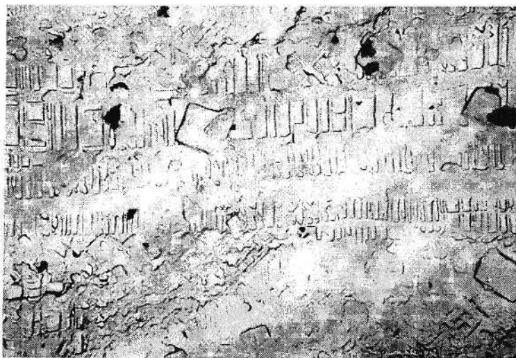
Рис. 34. Штриховидно-пластинчатые вросстки ульвошпинели по {100} магнетита, частично замещенные ильменитом, из массивной руды. Месторождение Малый Куйбас. Угольная реплика со скола магнетита, протравленного HCl. Увел. 1300
