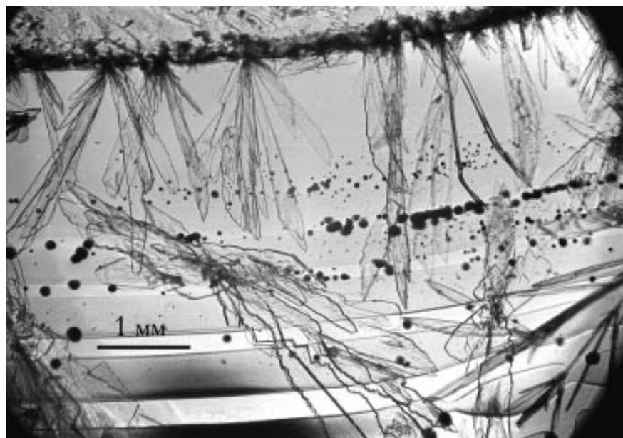
Рис. 3.1.3. Кристаллы брусита и сферокристаллы октакальцийфосфата в геле после завершения опыта
