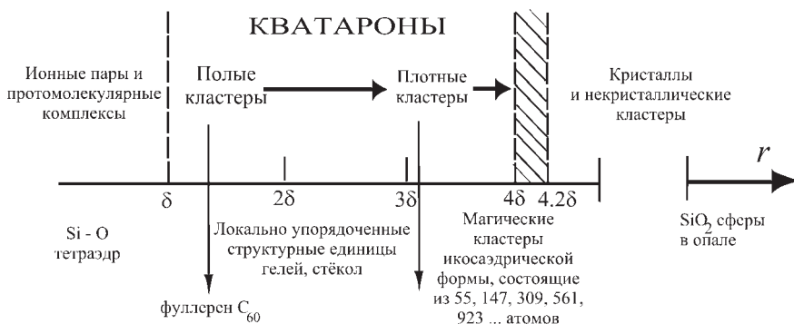
Рис. 1.2.5. Кватароны на размерной шкале наночастиц. Заштрихована область неизбежной кристаллизации плотных кластеров. В нижней части рисунка приведены наиболее известные примеры жестких структур, формирующихся в результате структурной эволюции кватаронов или иерархической агрегации некристаллических кластеров
