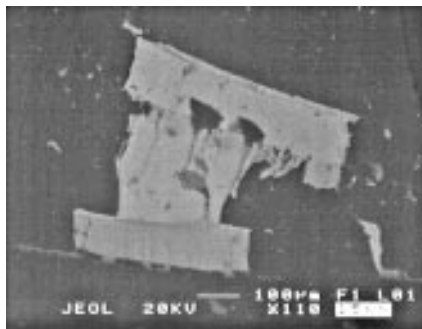
Рис. 2.2.5. Пленка железа (Шуньга, изображение в обратно-отраженных электронах)
