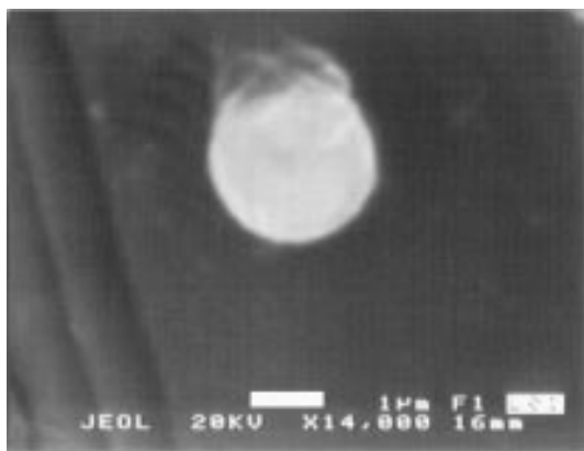
Рис. 2.5.3. Фосфатное включение, вскрытое при вакуумировании препарата кварца
