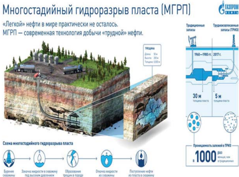
Рис. 3. Схема многостадийного гидроразрыва пласта
