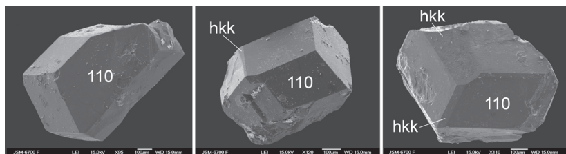
Рис. 1. Кристаллы андрадита (электронный микроскоп JSM-6700 F фирмы Jeol) гонтриоктаэдр {211}. На отдельных кристаллах наблюдаются ступени роста и отпечатки других минералов.
