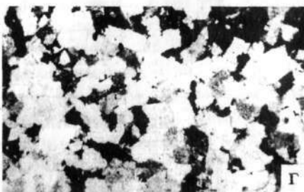
Рис. 4. Перекристаллизация доломитового мономинерального агрегата (а) при различных температурах гидротермального воздействия: 150°C (б), 250°C (в), 350°C (г). Шлиф, николи скрещены, увеличение 9×0.20.
