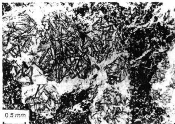
Рис. 3. Конкреционный диаспорит (обр. 6813): крупные поля чистого пирофиллита со «скелетными» кристаллами диаспора-2 в темном богатом гематитом матриксе.
