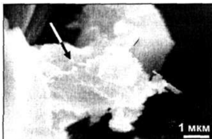
Рис. 4. Нарастание церанита на алмазную фазу в карбонадо. РЭМ-изображение в режиме вторичных электронов.
