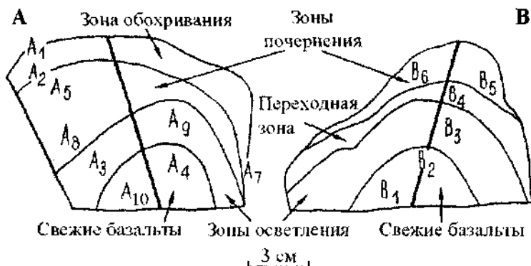
Рис. 1. Схема зонального строения образцов эпигенетически измененных базальтов. Составлена по рис. 1 в [8]. Жирной линией показаны профили опробования.
