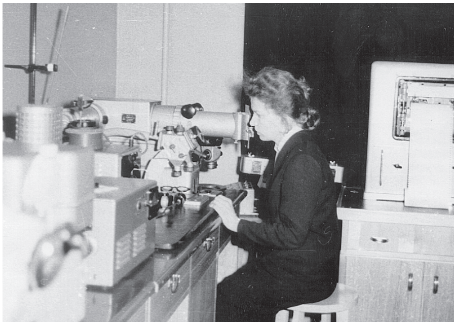
Снимаю спектр катодолуминесценции шеелита. Справа — термолуминесцентная установка. 1966 г.
