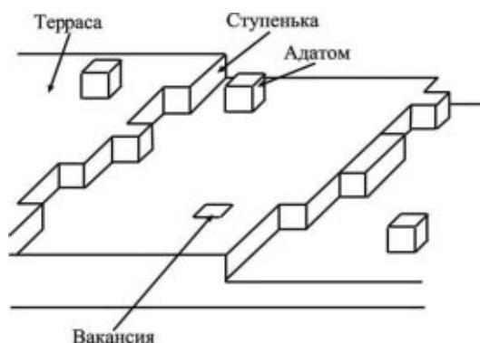
Рис. 1. Схема важнейших поверхностных дефектов
