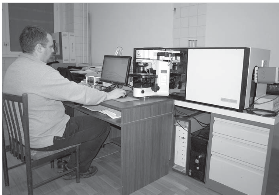
Рамановский спектрометр LABRAM HR800 фирмы Horiba Jobin Yvon (Франция) с внутренним и внешним источниками возбуждения спектров КР
