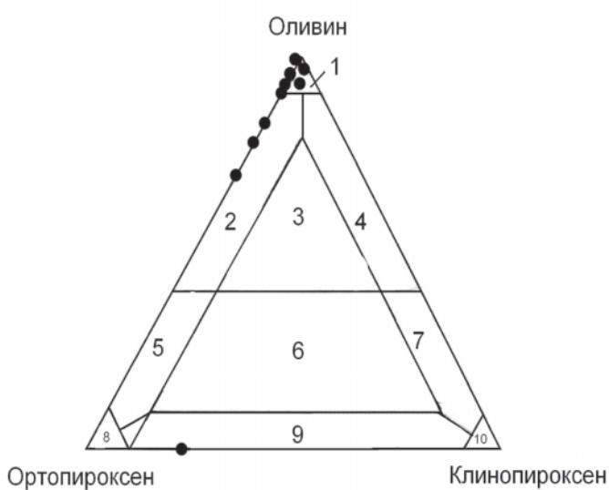
**Рис. 2.** Треугольник классификации ультраосновных магматических пород по их нормативно-минеральному составу.
