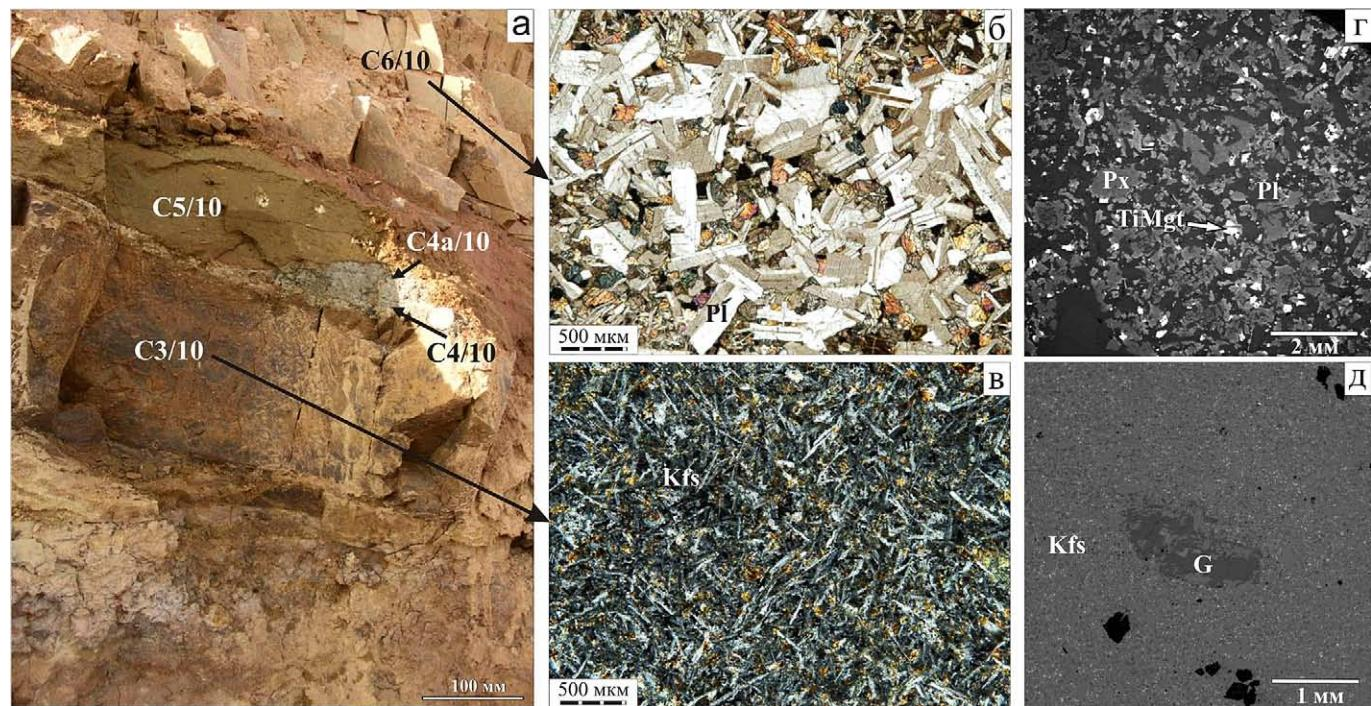
**Рис. 2.** Строение нижней части покрова: а — положение образцов в разрезе; б, в — примеры микроструктур базальтов (б) и ультракалиевых пород (в); г, д — изображение в обратно-рассеянных электронах базальтов (г) и ультракалиевых пород (д)
