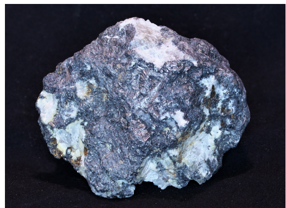
Рис. 4. Кварц-полевошпат-графитовая руда с высоким содержанием Au, Ag и Pt. Рудопроявление «Филинское», Приморье. № образца: 59/15. Размер: 9×7×7. Коллекция В. П. Молчанова, Д. В. Андросова. Фото Т. Б. Князевой
