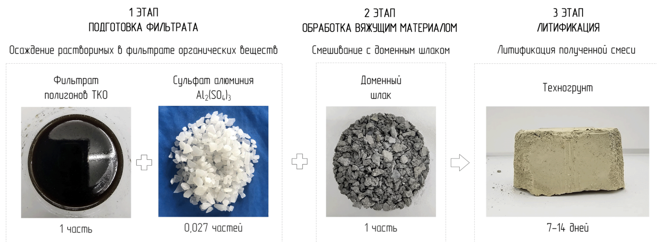
Рис. 1. Схема получения техногрунта на основе свалочного фильтрата
